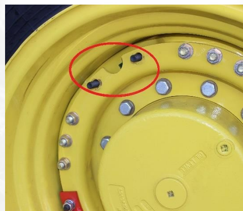
Рис. 2 Болт М16х90 із гайкою та гровером.
