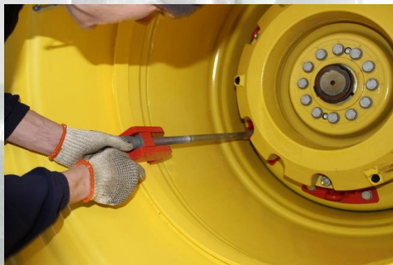
Рис. 7 Расположение замков и стяжек
