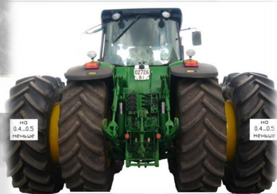
Рис. 8 Давление в шинах
