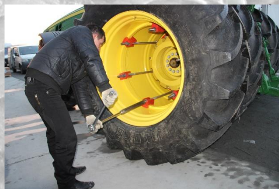
Рис. 8 Усилие затяжки замков
